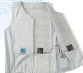
2001年モデル 市販の小型ファン4個を使い、服内の熱気を排気する
